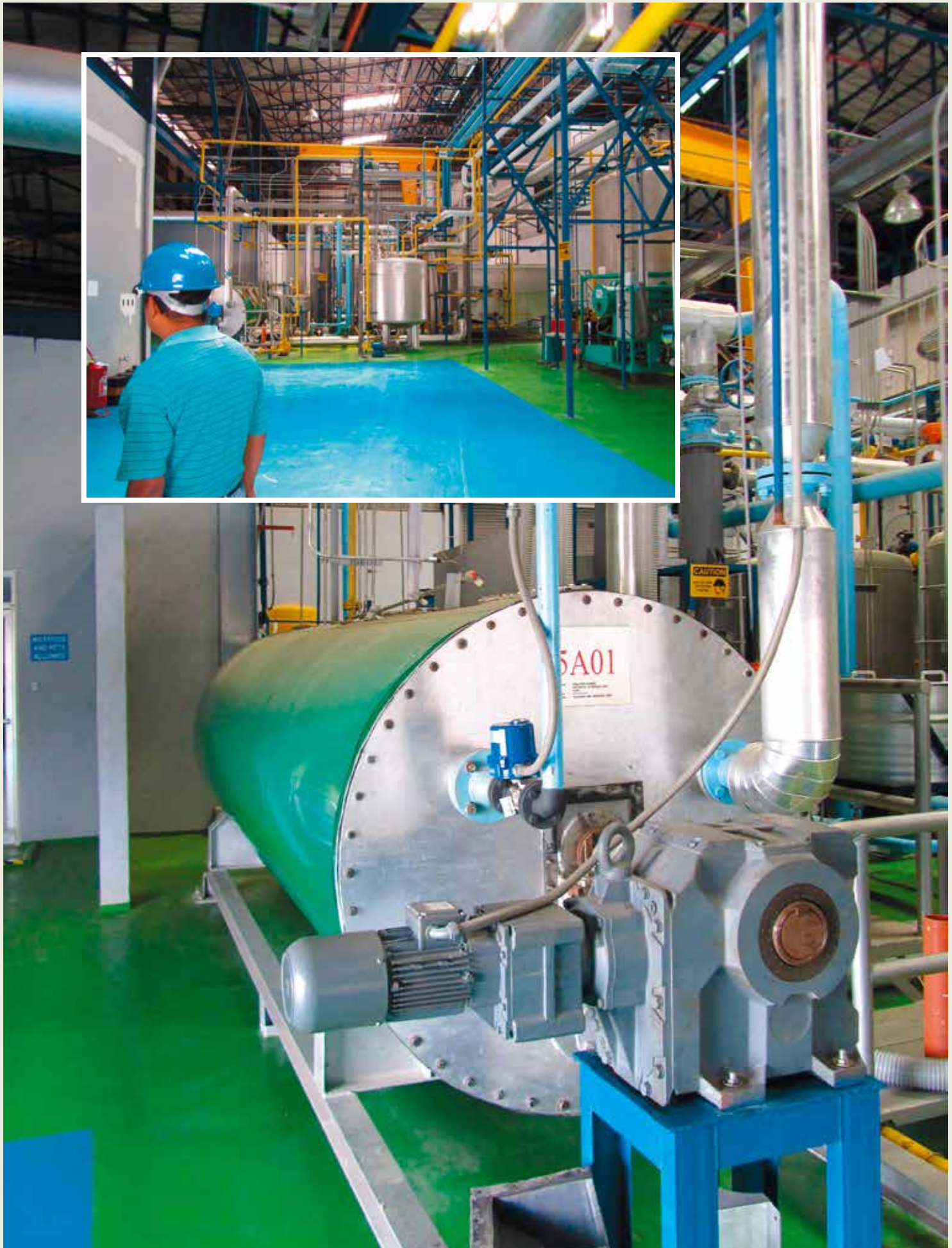
Восстановление натрием (SR) используется для уничтожения ПХД масел в Филиппинах.
