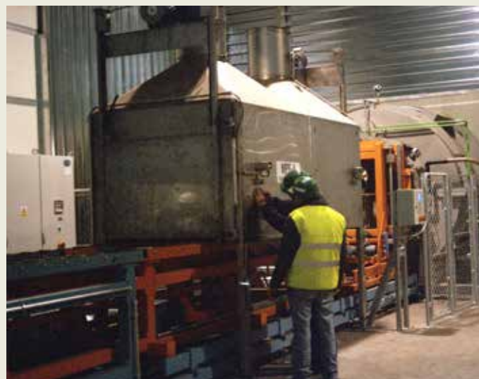
Муфельная печь в заводе технологии КОР для восстановления диоксинами и пестицидами загрязненного участка в Сполане Неративице.
