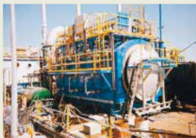
Химическое восстановления в газовой фазе (GPCR) – технологический реактор, используемый для восстановления в Австралии.
